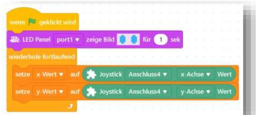
Überprüfe damit die Funktion des Joysticks, bestimme die Bereichsgrenzen der Messwerte sowie den Messwert für die Ruhelage für die x- und y-Richtung.
