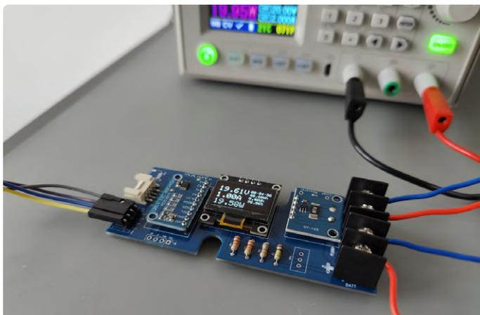
Bild 6. AmpVolt-Modul im Testaufbau.
