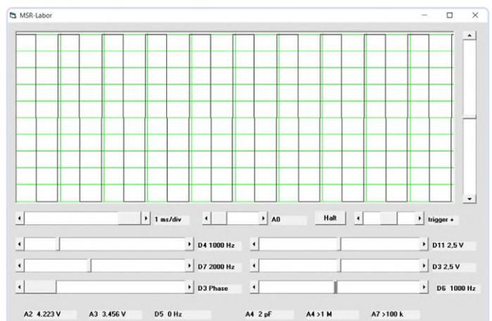
Bild 4. Ausgabe und Anzeige eines 1.000-Hz-Signals.
