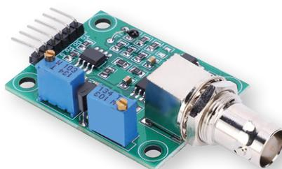
Bild 3. Die Platine mit der Signalverarbeitungselektronik ermöglicht den Anschluss der pH-Sonde an den Arduino UNO R4. (Quelle: Elettronica In)
