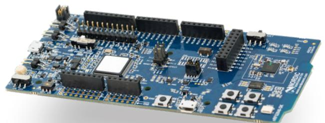
*Bild 1. Das nRF52840 Development Kit von Nordic Semiconductor unterstützt sowohl Matter als auch Arduino UNO REV 3-Shields. (Quelle: Mouser Electronics)*
