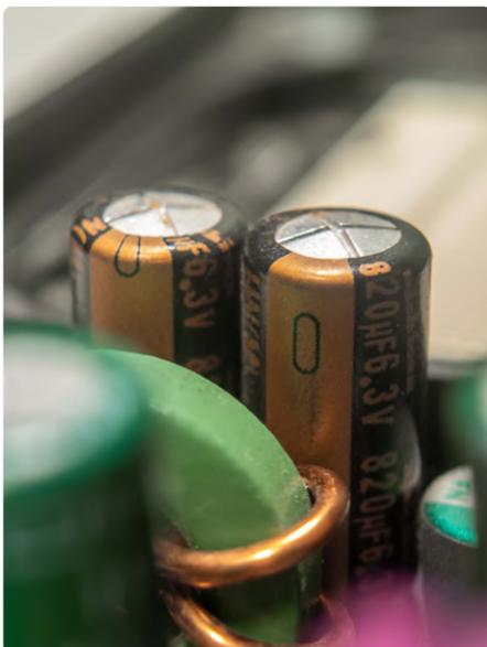
Bild 4. Die berühmten Elektrolytkondensatoren mit wulstiger Kappe. (Quelle: Wikipedia [3])
