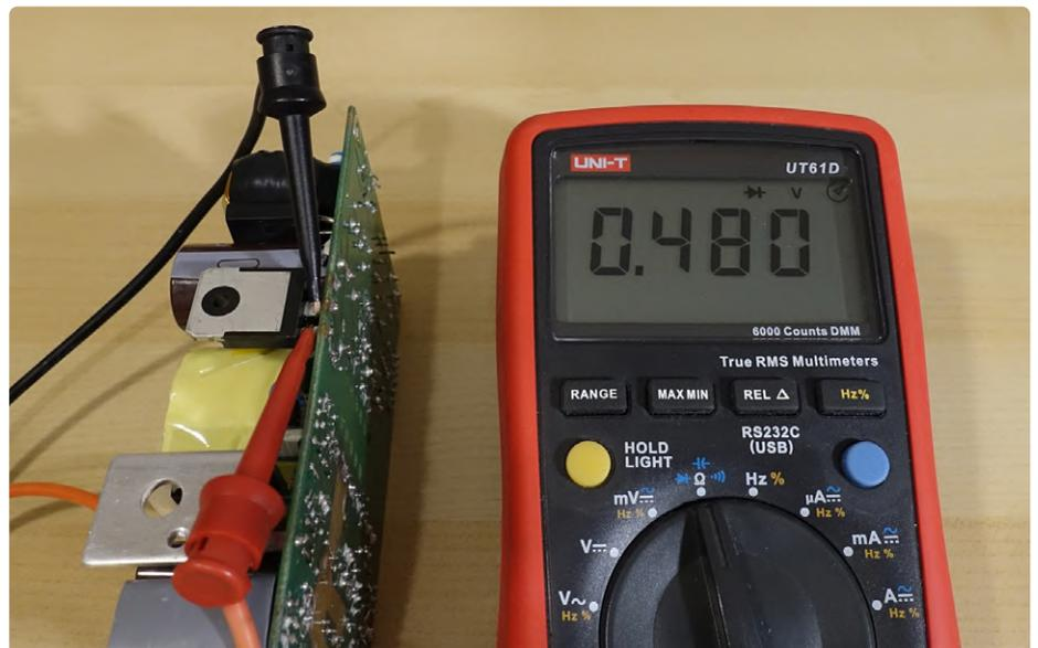
Bild 5. Prüfung eines Leistungs-MOSFETs mit Hilfe eines DMM im Diodenmodus.
