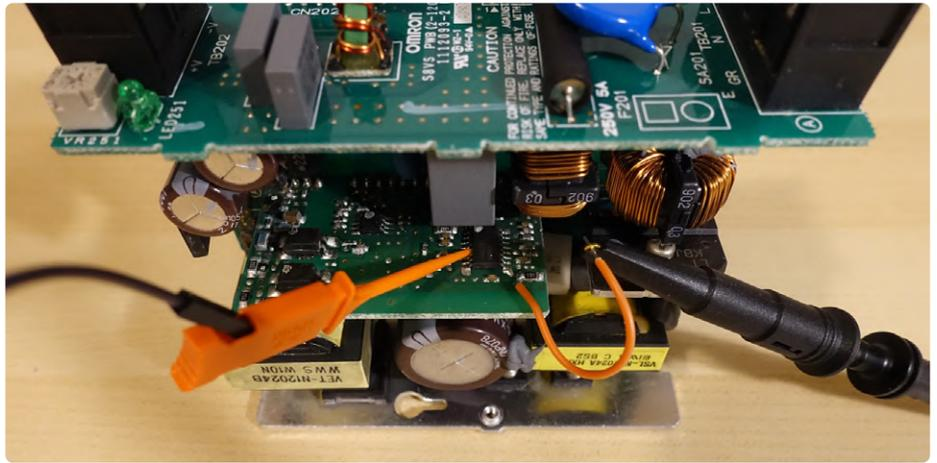
Bild 3. Sicheres Prüfen von Stromkreisen unter Spannung.
