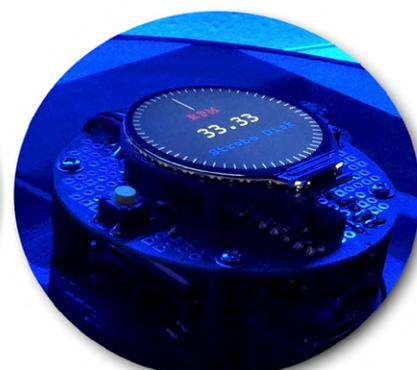
Bild 3. Eine traditionelle Stroboskop-Scheibe (links) und eine digitale, aktive Scheibe (rechts). (Quelle für das Bild der Scheibe: Wikimedia Commons [https://de.wikipedia.org/wiki/File:Stroboscopic\\_disc.svg](https://de.wikipedia.org/wiki/File:Stroboscopic_disc.svg))
