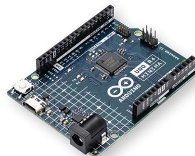
Bild 4. Arduino UNO R4 Minima.
