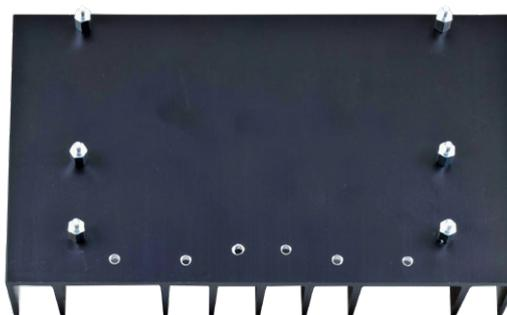
Bild 13. Die fertigen Bohrungen zur Befestigung der Leistungstransistoren.
