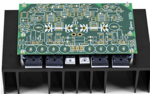
Bild 11. Markieren der Löcher für die Leistungstransistoren. Für höhere Genauigkeit werden den Transistoren die Keramik-Pads unterlegt.
