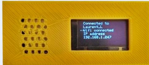
Bild 5. Eine drahtlose serielle Debug-Einheit im 3D-gedruckten Gehäuse.
