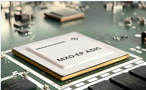
Bild 3. Rohde & Schwarz hat einen intern entwickelten 200-Gbit/s-ASIC für die Signalverarbeitung in das neue R&S MXO 4 integriert.
