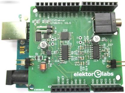
Bild 4. Das SDR-Shield.
