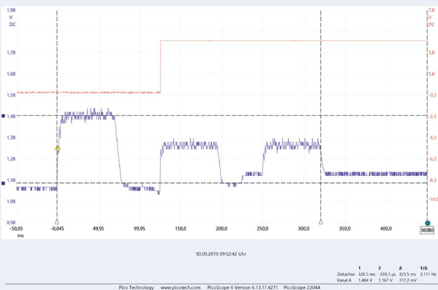
Bild 2. Die Auswahl des mittleren Impulses ist zeitkritisch.
