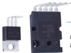
Bild 10. So werden die Anschlussdrähte der Leistungstransistoren gebogen.
