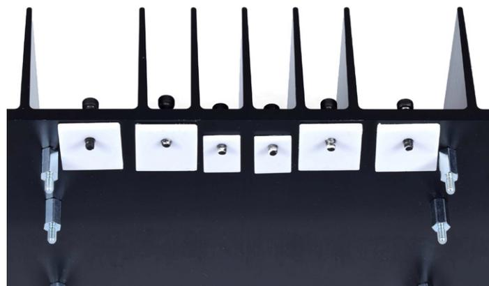
Bild 21. Die Keramik-Pads werden auf einer Seite dünn mit Wärmeleitpaste bestrichen und auf die halb durchgesteckten Schrauben geschoben. Dazu wird der Kühlkörper aufgerichtet.
