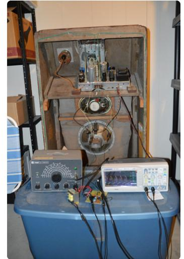
Bild 10. Der Low-Q-Verstärker wird zur Messung der Frequenz einer Schleifenantenne eines antiken Konsolenradios verwendet.
