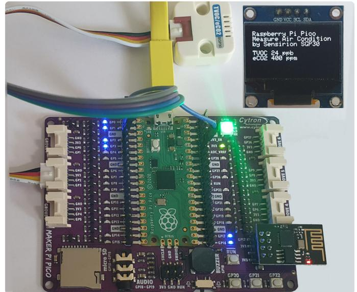
Bild 10. Messung der Luftqualität mit Sensirion SGP30 und Raspberry Pi Pico.
