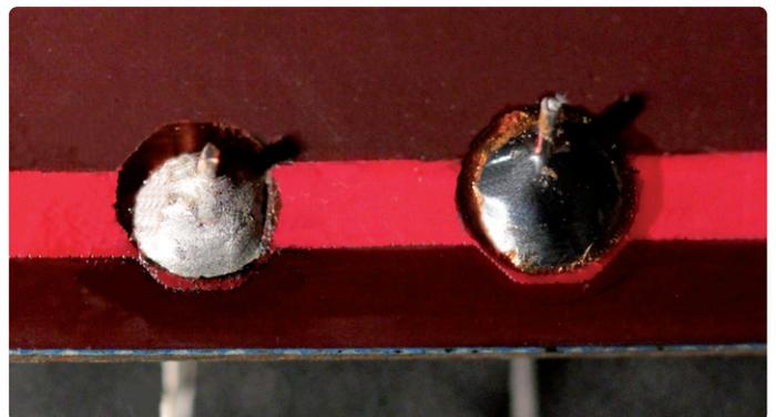
Bild 3. Eine andere Optik: bleifreie Lötstelle (links) und Lötstelle mit bleihaltigem Lot (rechts).
