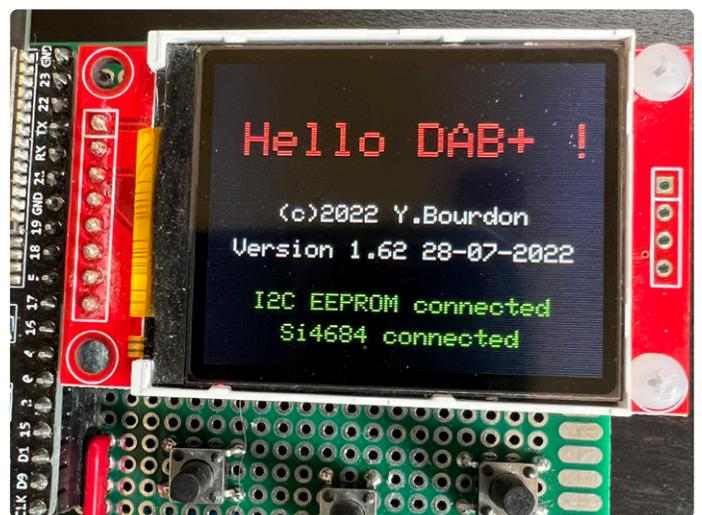
Bild 5. Die Softwareversion und der Verbindungsstatus der Hardware werden im Display angezeigt.
