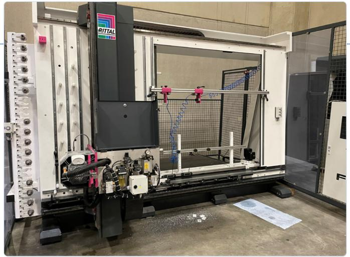
Bild 1. Industrieschneider von FEGA & Schmitt mit Überwachung. (Quelle: Würth Elektronik eiSos)
