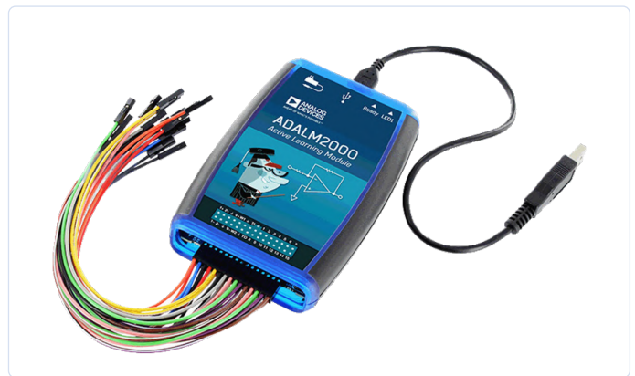
Bild 6. Der ADALM2000 (M2K) gehört jetzt zur Standardausrüstung der FAEs von Analog Devices und umfasst ein Oszilloskop, einen Funktionsgenerator, einen Logikanalysator und einen Mustergenerator. (Quelle: Analog Devices)
