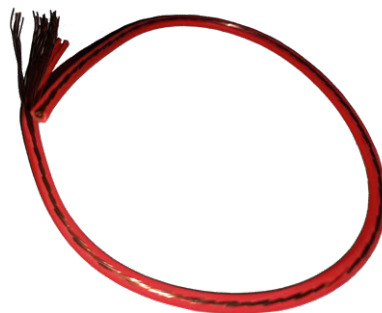
Bild 2. Drähte für den Anschluss der US-Wandler.
