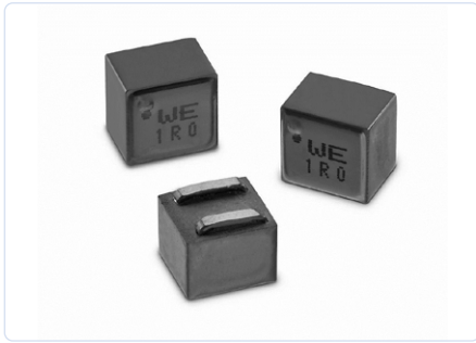
Bild 6. Die Spulentypen WE-XHMI und WE-PD2 mit dem „Punkt“, der den Windungsanfang anzeigt.
