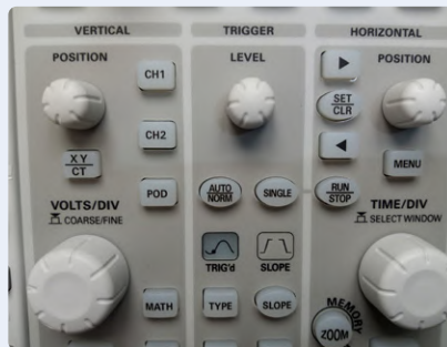
Bild 4. Die drei wichtigsten Steuerbereiche eines jeden Oszilloskops: Vertical, Horizontal und Trigger.
