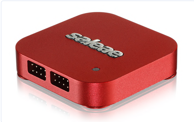
Bild 3. Das Einstiegsmodell Logic 8 von Saleae bietet acht Kanäle für die Mixed-Signal-Erfassung in einem winzigen quadratischen Aluminiumgehäuse mit einer Kantenlänge von nur 5,3 cm. (Quelle: Saleae)
