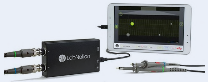
Bild 3. Ein Oszilloskop ohne Display spart Platz auf der Werkbank. Oder doch nicht? Für die Anzeige der Signale ist nämlich ein Computermonitor oder ein Tablet erforderlich.
