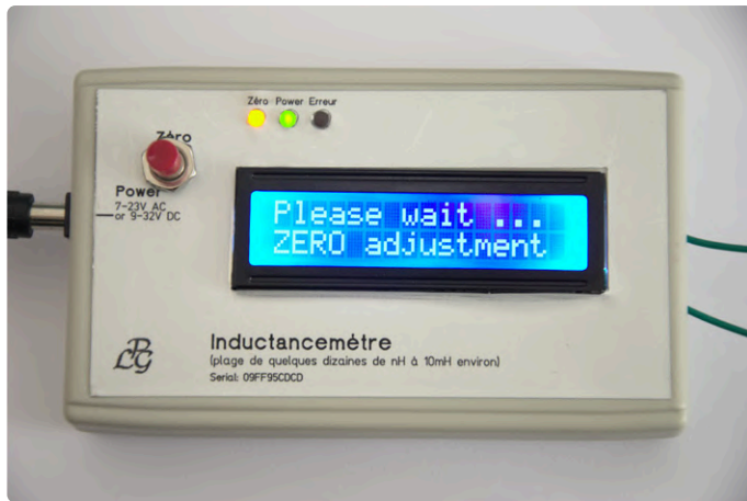
Bild 4. Für die beste Genauigkeit wird jede Messung in zwei Schritten durchgeführt. Hier ist als Schritt 1 die Systemkalibrierungssequenz dargestellt.
