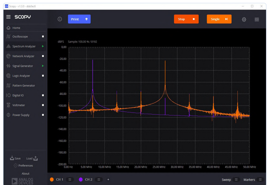
Bild 7. Die Benutzeroberfläche (GUI) ist entscheidend für den Erfolg eines jeden Headless-Messgeräts. Scopy bietet für alle Betriebssysteme und auf Android-Tablets einen klaren Zugang zu seinen Funktionen und Einstellungen. (Quelle: Analog Devices)
