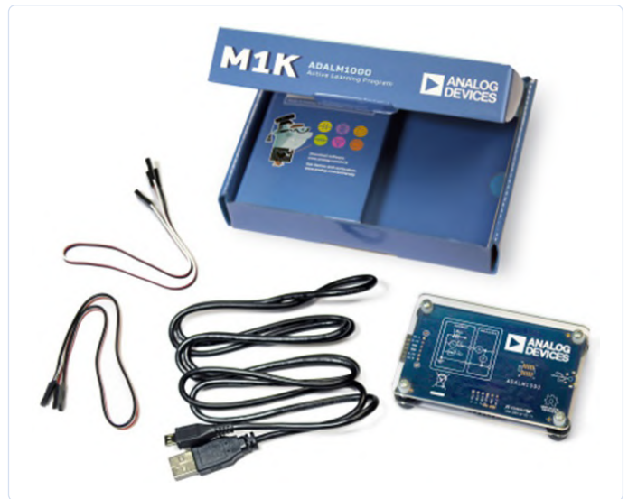
Bild 5. Mit dem ADALM1000 (M1K) können Studenten der Elektrotechnik ein komplettes Labor in ihrem Wohnheim oder zu Hause nutzen. (Quelle: Analog Devices)
