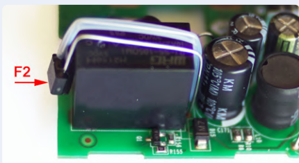
Bild 32. Thermosicherung und Relais eng umschlungen.
