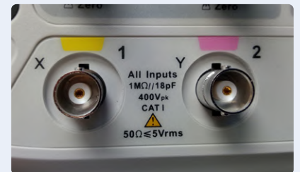
Bild 5. Die Eingänge X und Y werden im XY-Modus verwendet und ermöglichen beispielsweise die Darstellung von Lissajous-Figuren.
