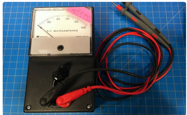
Bild 8. Die Kalibrierung des Messgeräts ist mit ein paar 2- \Omega -Widerständen leicht zu bewerkstelligen.
