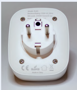
Bild 9. Vier Schrauben halten das EU6S-Gehäuse zusammen.
