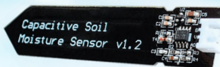
Bild 3. Beispiel eines niederfrequenten kapazitiven Sensors (Quelle: [3]).
