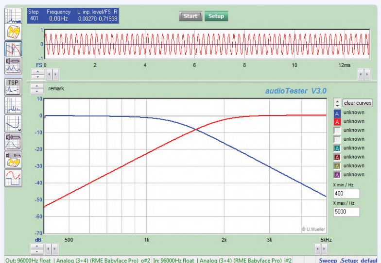
Bild 15. Frequenzgänge eines 12-kHz-Tiefpasses und eines 2-kHz-Hochpasses (beide Butterworth) mit logarithmischer Frequenzskala.
