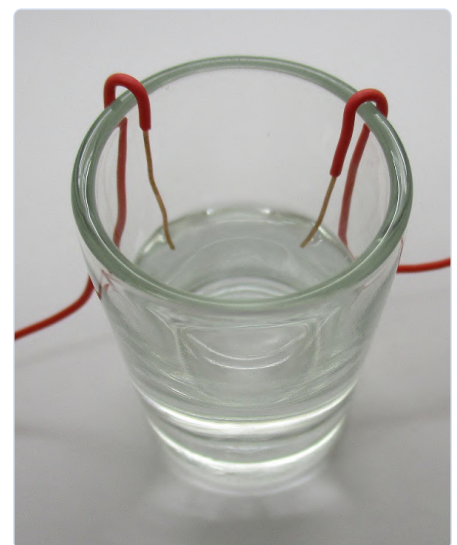
Bild 6. Experimenteller Aufbau eines Doppelschichtkondensators.
