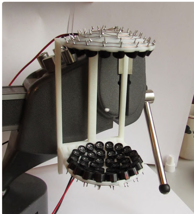
Bild 4. Eine winzige Styroporkugel, die im TinyLev schwebt.
