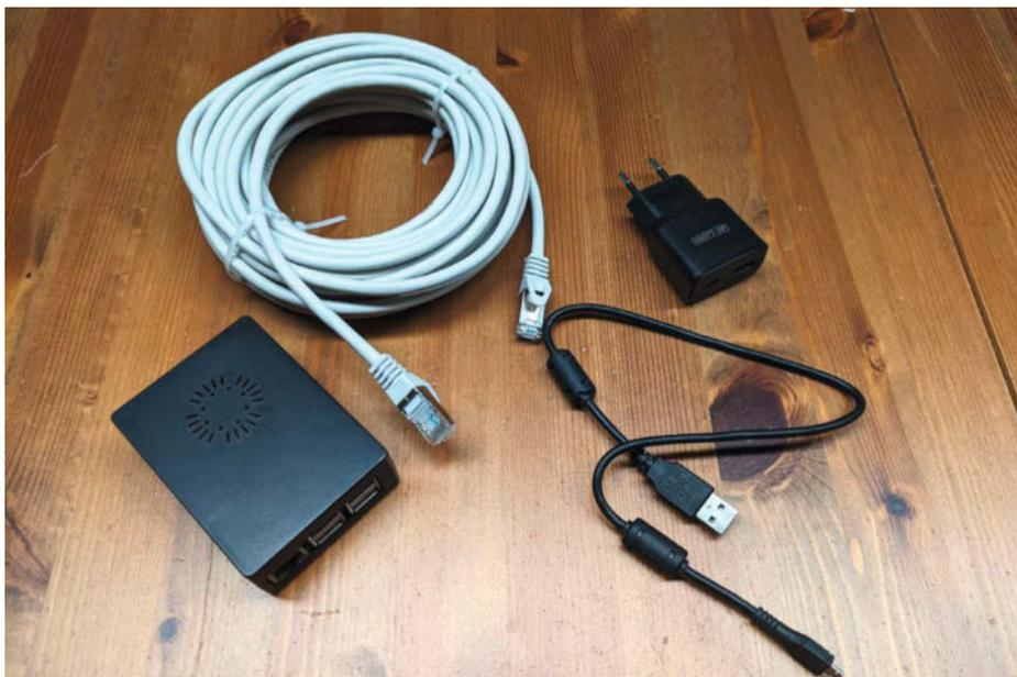
Bild 6: Raspberry Pi 3B mit Stromversorgung und LAN-Kabel
