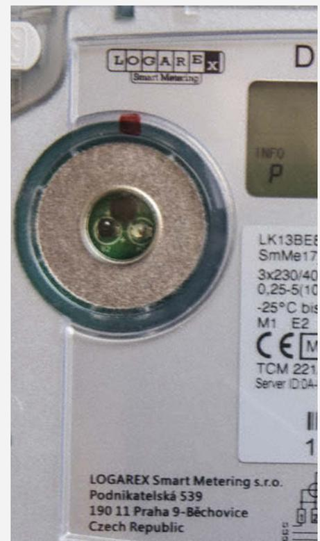
Hier ist die Sende- und Empfangsdiode auf dem Stromzähler gut zu erkennen.
