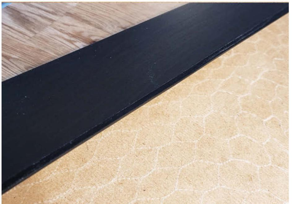
Abbildung 9: Beschädigungen an der Schnittkante und die Reparatur mit d-c-fix-Klebefolie.
