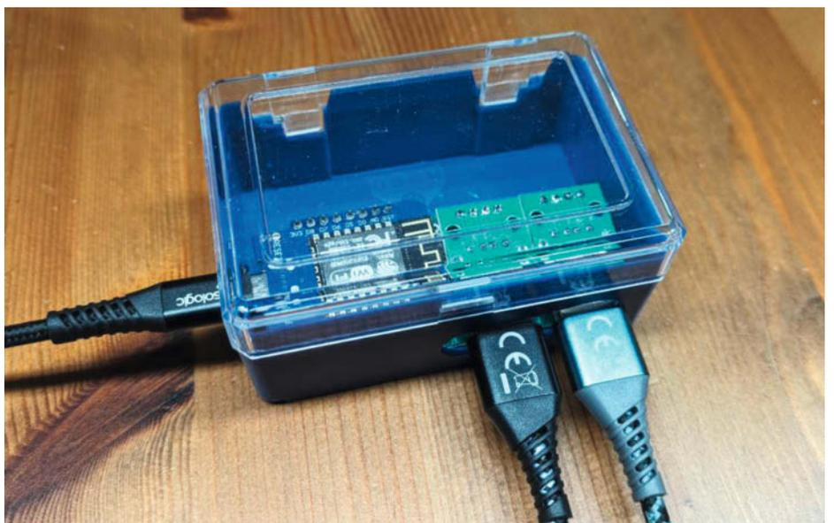
Bild 5: Ins Kunststoffgehäuse müssen Öffnungen für die Sensorstecker und das USB-Kabel zum Netzteil geschliffen werden.
