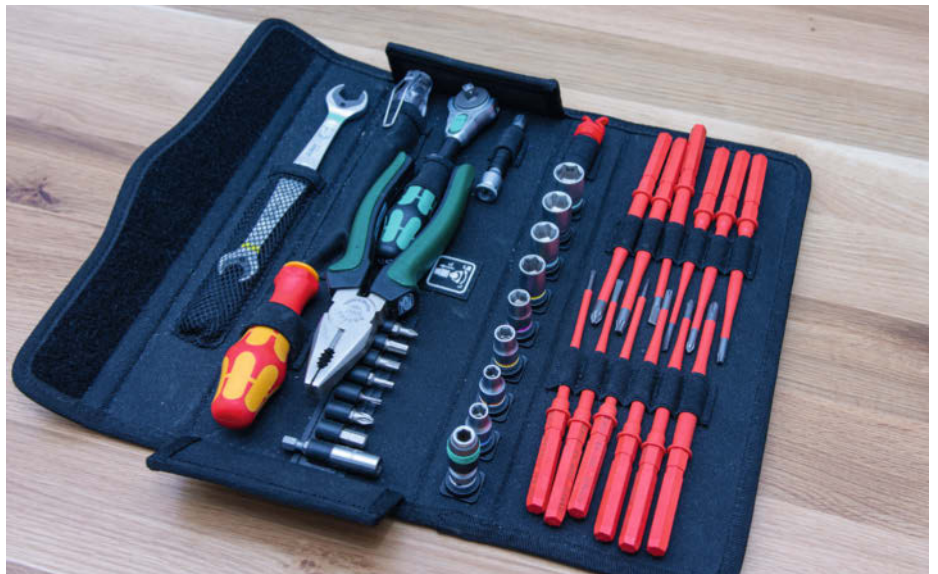
Dominik Laas Werkzeugset besteht aus einem Satz Ratschen, Schraubendrehern, häufig genutzten Bits, einem Spannungsprüfer und einem Schraubenschlüssel.
