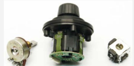
Von links nach rechts: Potentiometer, Hall-Joystick und Mini-Joystick
