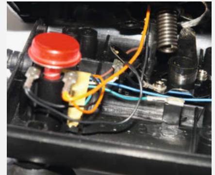
Ein einfacher Joystick; die Spiralfeder sorgt für die Zentrierung, die Kontakte sind aus Federblech.
