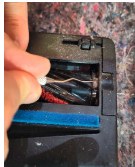
Um diese Bürste von Haaren zu befreien, braucht man ein feines Werkzeug.
