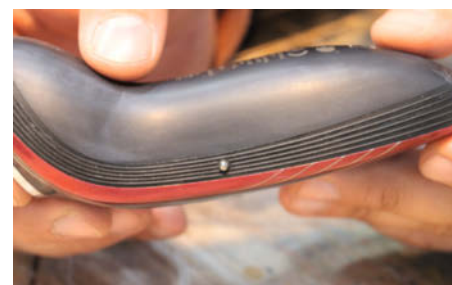
Nach zwei bis drei Durchgängen ist nur der darunterliegende Kunststoff übrig – wenn auch mit leichten, weißen Schlieren.
