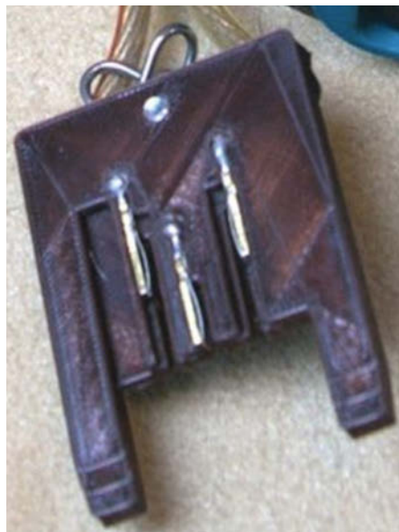
Bild 7: So sollen die XT-Federkontakte im Gegenstück sitzen.
