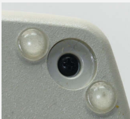
Wenn der Gummifuß beim Abnehmen kaputtgeht, gibt es im Fachhandel selbstklebende Füße.
