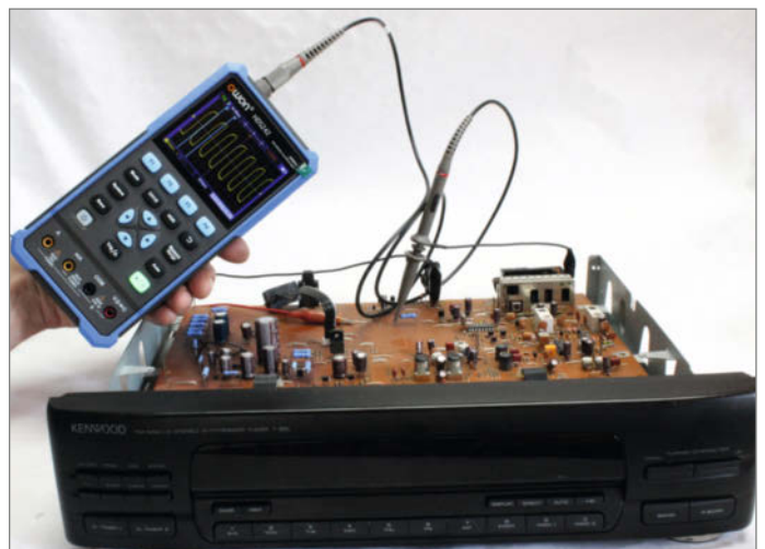
Fehlersuche an einem Kenwood-Tuner mit einem portablen Oszilloskop.
