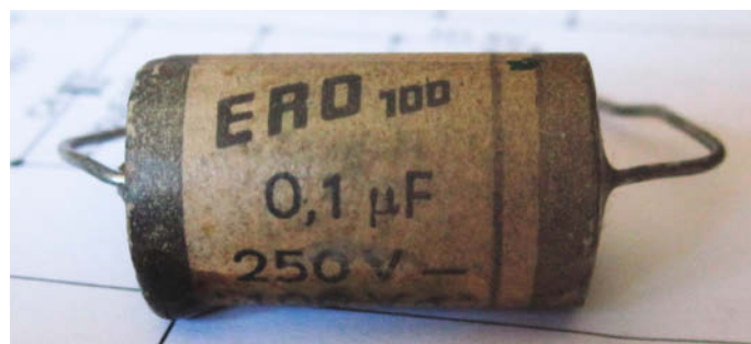
Bild 9: Papierkondensatoren reagieren sehr stark auf Luftfeuchtigkeit. Daher ist ein Defekt schwer zu erkennen. Am besten tauscht man sie pauschal aus.
