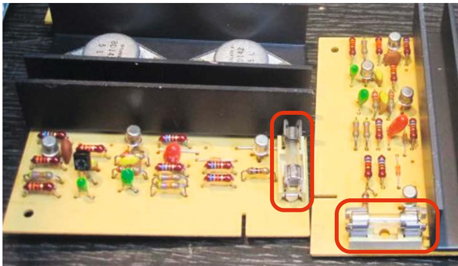
Bild 4: Die Endstufen mit neuen Sicherungshaltern
