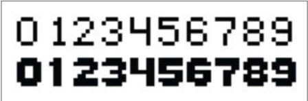
Bild 8: Zwei Zeichensätze im Vergleich: 5 × 7 Pixel (oben) und 6 × 7 Pixel (unten).
