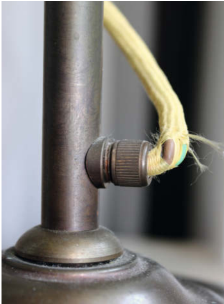
Das defekte Anschlusskabel einer alten Stehlampe kann schnell lebensgefährlich werden.
