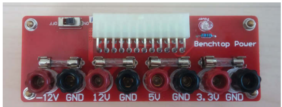
Variante 1: Vier Ausgangsspannungen sind hier über Bananenbuchsen abgreifbar.
