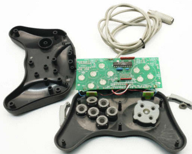
Leiterbahnen und ein Gummidom mit leitfähigem Plastik (schwarz) bilden einen billigen, aber zuverlässigen Schalter.
