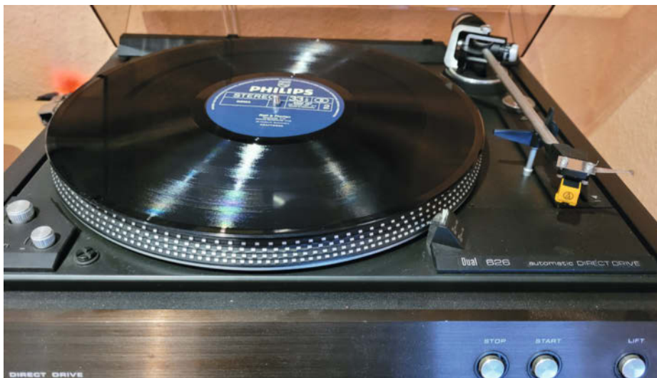
Ein Dual CS626, Made in Germany, war der erste mit Frontbedienung auch bei geschlossener Klappe. Seine Gleichlaufschwankung lag unter 0,05% und sein Rumpelgeräuschabstand bei 75dB.
