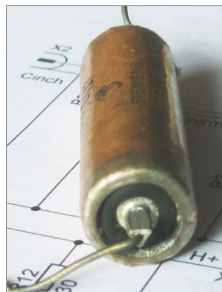
Bild 4: Siemens-Elko. Die schwarze Gummidichtung ist rausgedrückt, der Elektrolyt klebt auf der Platine.
