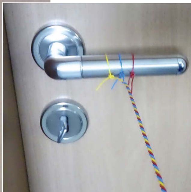
Hier werden drei Litzen verdrillt, die Türklinke ersetzt den Schraubstock.
