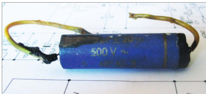
Bild 8: Teer- und Wachs-Kondensatoren findet man in Geräten bis Mitte der 1950er. Sie zeigen ihr Ableben durch das Ausschmelzen der Bitumen- oder Wachsfüllung. Man kann sie gut mit modernen Folienkondensatoren ersetzen.
