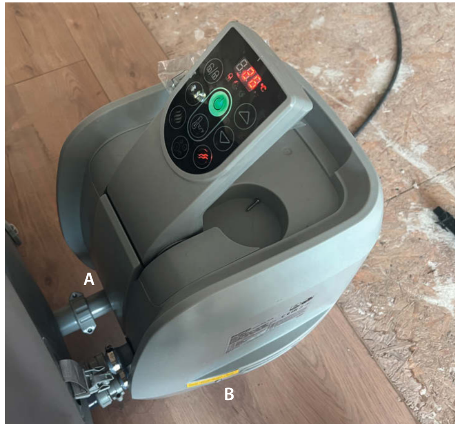
6 Schrauben halten von unten das Gehäuse fest: 2 Schrauben mittig an Position A und 4 Schrauben seitlich, rechts und links an Position B.
