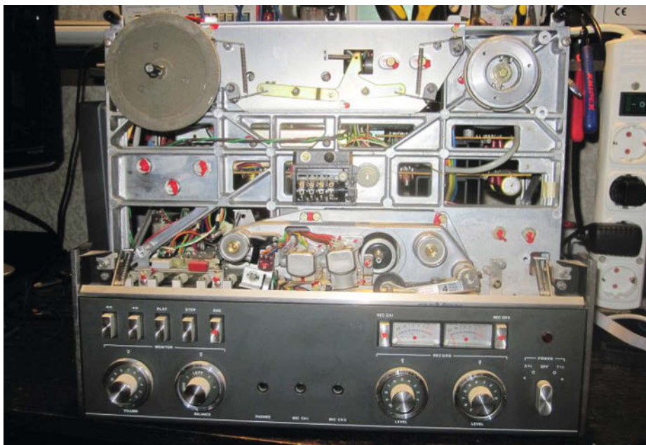
Bild 3: Ist die Kunststoff-Vorderseite abgeklipst, kommt das stabile Metallguss-Chassis zum Vorschein.
