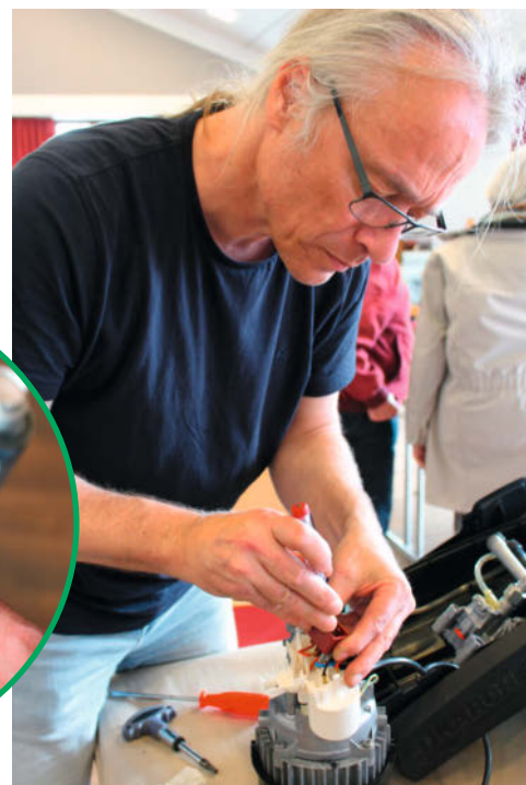
Arbeiten an einem Hochdruckreiniger. Der Fehler fand sich im Inneren eines Geräteschalters.
