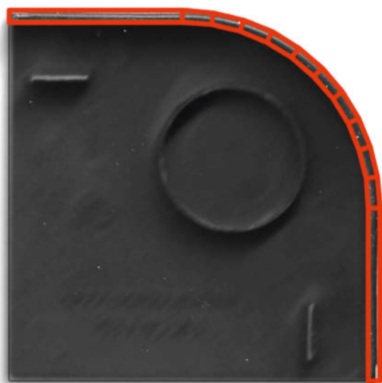
Bild 8: Der extrudierte Rand hat umlaufend eine Dicke von 1 mm.
