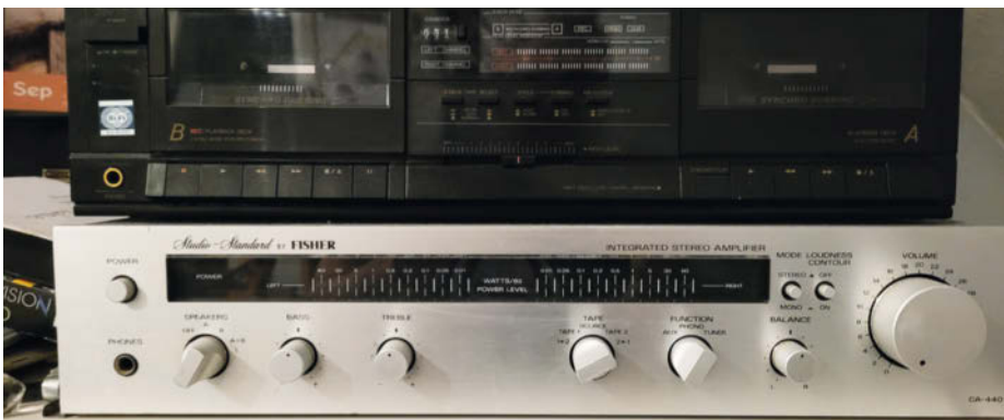
Ein Fisher-Receiver CA-440 mit 2 x 30W. Über seine Frontschalter kann man verschiedene Boxenpaare ansteuern.
