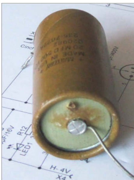
Bild 3: US-Amerikanischer Mallory-Elko. Das Überdruckventil ist offen und Elektrolyt ausgetreten.
