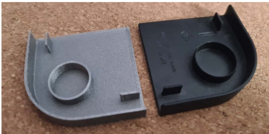
Bild 12: Das 3D-gedruckte Teil sieht fast genauso gut aus wie das Original.
