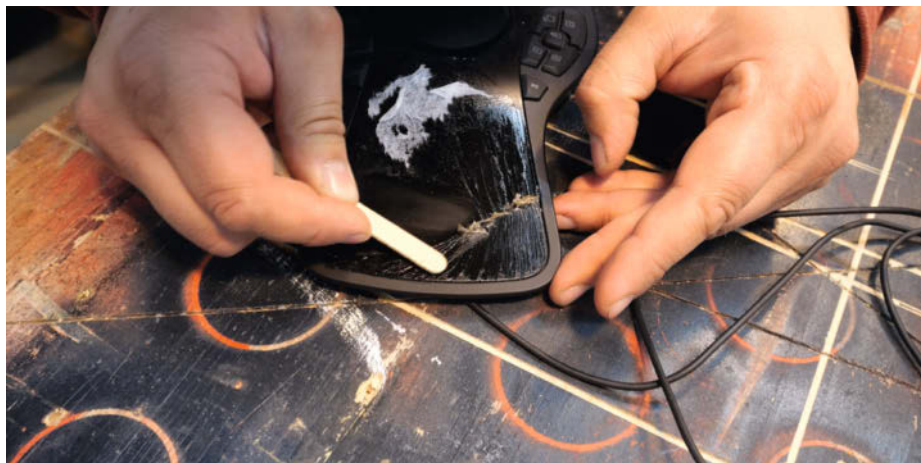
Mit einem Holzspatel oder Eisstiel lässt sich ein Teil der Beschichtung auf einen Haufen schieben. Anschließend geht es mit den Reinigern ans Werk.
