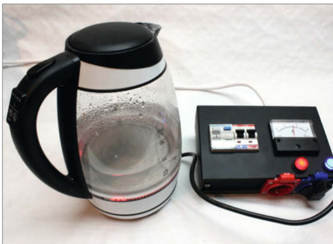
Arbeitsplatz-Stromversorgung mit Sicherheitsfeatures
