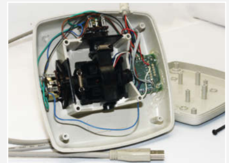
Von links nach rechts: Potentiometer, Hall-Joystick und Mini-Joystick
