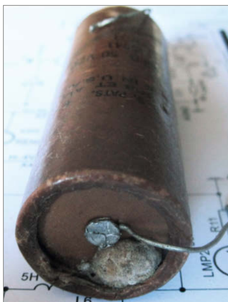
Bild 2: US-Amerikanischer Mallory-Elko. Man erkennt deutlich den ausgetretenen Elektrolyt.
