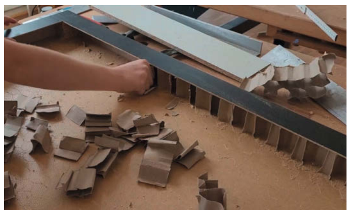
Entfernen der Stützstruktur aus Pappe. In der oberen Ecke ist der Verstärkungswürfel aus Holz zu sehen, der beim Prototyp noch nicht vorhanden war.
