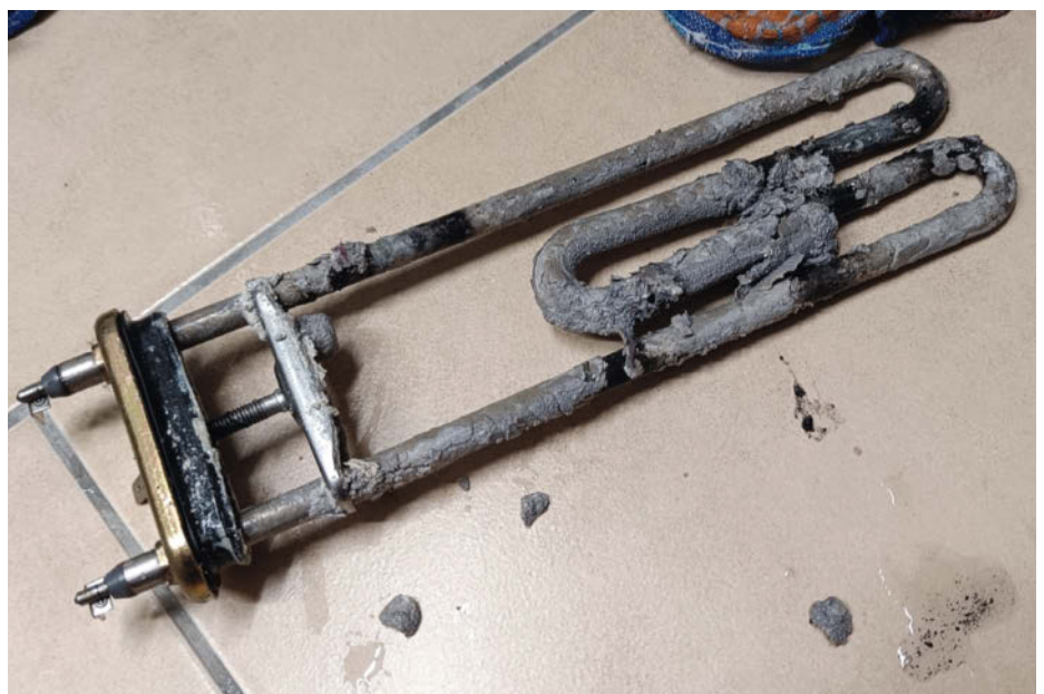
... und große Reparaturen: der alte Heizstab nach über 20 Jahren Betrieb
