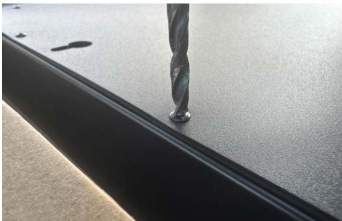
Bild 1: Nieten statt Schrauben. Mit einem Metallbohrer aber kein Problem
