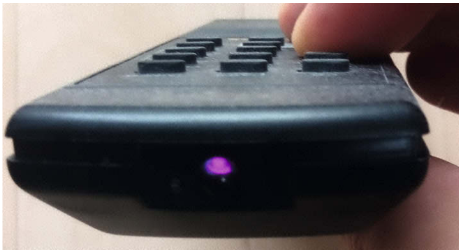
Bei gedrückter Taste wird das Blitzen der IR-Diode im Bild der Handykamera sichtbar.
