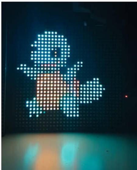
hinzu. Strahlt das Bild zu grell, dimmt man mit der Option `--led-brightness=50` auf 50 Prozent Helligkeit oder beliebige andere Werte herunter. Eine vollständige Liste aller Optionen finden Sie im Github-Repo des Tools. Apropos dimmen: Anders als bei NeoPixels oder WS2812B-LEDs können bei LED-Paneln die LEDs nicht einzeln per PWM in der Helligkeit gesteuert werden.
