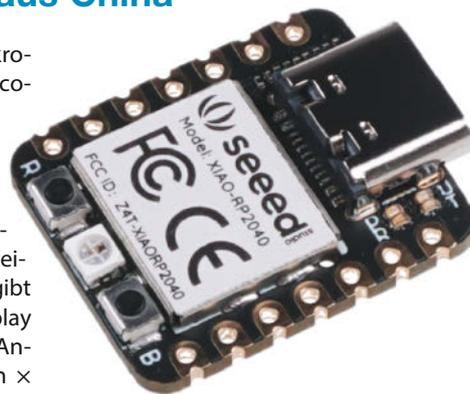
stehen *MicroPython*, die Arduino-IDE und *CircuitPython* bereit, zum Flashen dient die USB-3-C-Buchse. —cm
