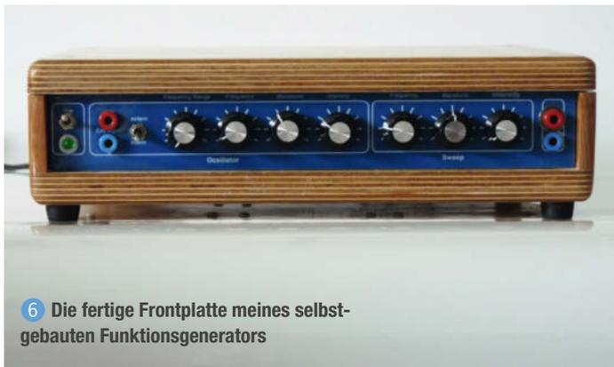
6 Die fertige Frontplatte meines selbstgebaute Funktionsgenerators
