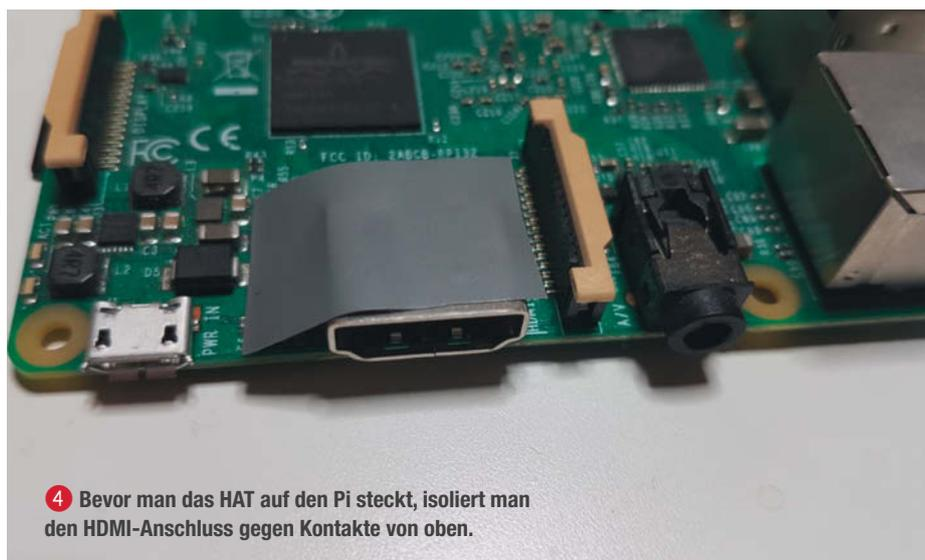
4 Bevor man das HAT auf den Pi steckt, isoliert man den HDMI-Anschluss gegen Kontakte von oben.
