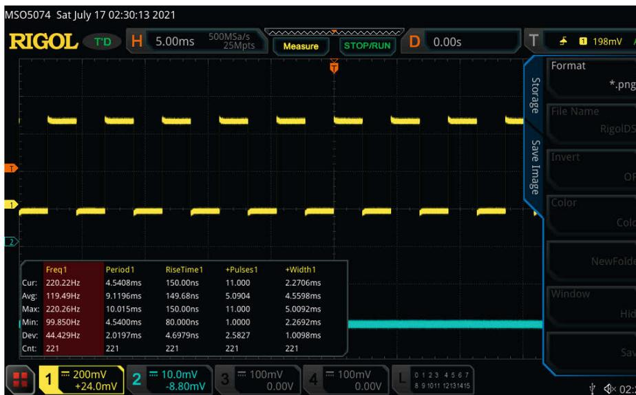
Bei einer Ansteuerfrequenz von 220 Hertz läuft der Föhn auf der mittleren Stufe.
