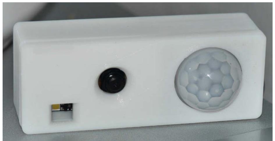
Die Kamera im eigens 3D-gedruckten Gehäuse
