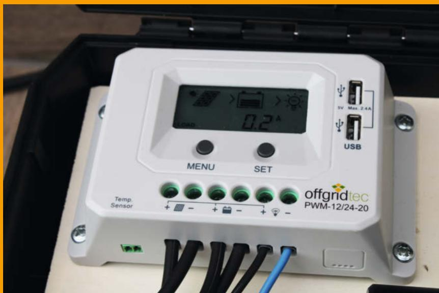
Das Herzstück, der Solar-Wechselrichter. Dieser übernimmt das Laden der Batterie und bietet direkt für zwei USB-Geräte Spannung.
