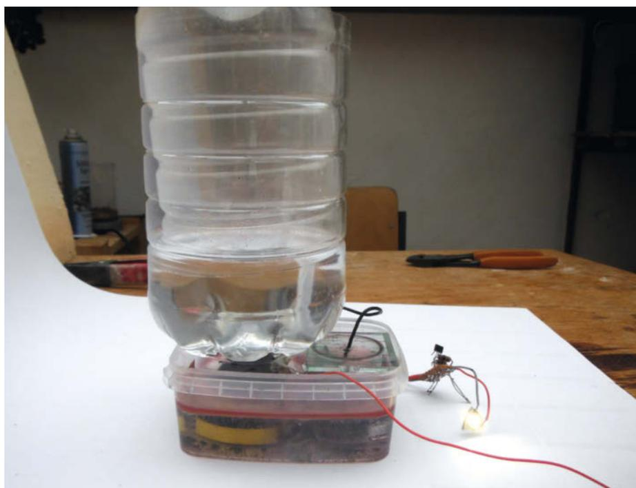
Seitenansicht: Links befindet sich der Sauerstoffbehälter und die Gasdiffusionselektrode, rechts erahnt man den Behälter mit der Zinkelektrode.
