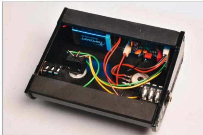
Beispiel-Aufbau mit unserer Platine im Gehäuse des FS-2. Die abnehmbaren Plastik-Seitenteile sind besonders einfach zu bearbeiten, deshalb haben wir Stromversorgungs- und Klinkenbuchsen hier montiert. Durch die kurzen Leitungswege sind abgeschirmte Kabel hier überflüssig.
