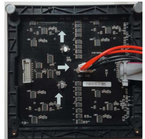
**2** Ein Panel von hinten: Die jeweils drei links oben, links unten, rechts oben und rechts unten angeordneten ICs sind Schieberegister mit 16 Ausgängen. Im unteren und oberen Segment jeweils 2 × 16 Ausgänge für je R, G und B in den 32 Spalten. An der Eingangsbuchse ist ein Pegelwandler und rechts daneben sind zwei Multiplexer zum Steuern der jeweils 16 Zeilen im oberen und unteren Segment.
