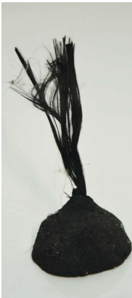
Die gebrannte Elektrode, das Roving schaut auf der Oberseite heraus.
