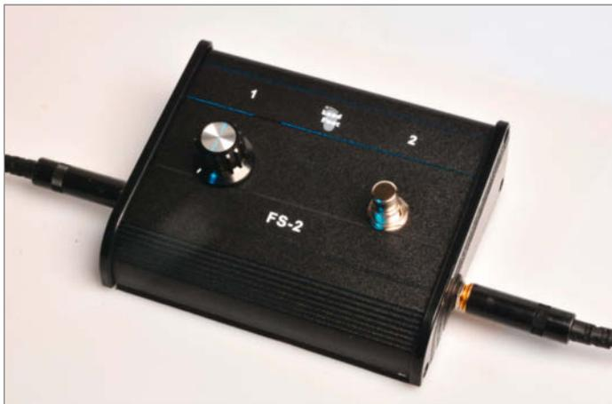
Fertiger Aufbau des Boosters: Sie sollten jetzt vom FS-2 ein zweipoliges Klinkenkabel und einen Tretschalter übrig haben. Die Stromversorgung wird durch Einstecken des Gitarrenkabels eingeschaltet, einen separaten Ein-Ausschalter gibt es nicht.
