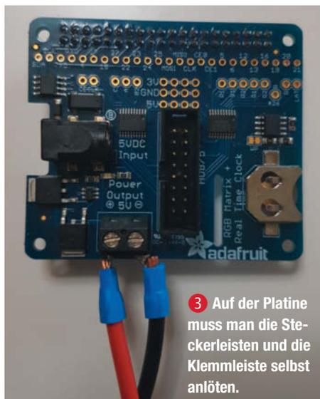
3 Auf der Platine muss man die Steckerleisten und die Klemmleiste selbst anlöten.
