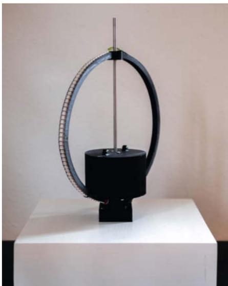
7 Gesamter Aufbau des Displays mit Sockel, Rotor-Ring und den LEDs
