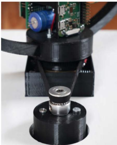
6 Motor in der Fassung mit montierter Zahnscheibe und Zahnriemen
