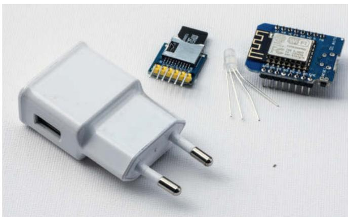
4 Das sind die Zutaten für unseren Bauvorschlag: WEMOS-1-Modul, Micro-SD-Kartenadapter, Neopixel-LED und ein USB-Netzteil
