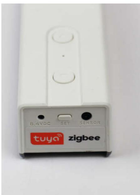
5 Der Set-Taster ist an der Motor-Unterseite.
