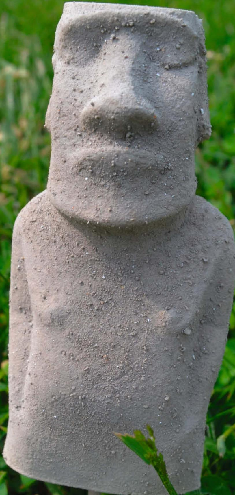
**A**uch wenn 3D-Drucke eine ganz eigene Ästhetik haben, möchte man mitunter die Oberfläche bearbeiten, etwa um die Plastikoptik zu kaschieren. Schleifen ist natürlich immer möglich, je nach Objekt aber sehr aufwändig. Alternativ kommt auch ein Farbauftrag infrage. Im Bastel- und Künstlerbedarf gibt es auch Effekt-Farben und Sprühlacke, die eine metallische oder gar eine raue, wie Beton wirkende Oberfläche versprechen. Oft sind diese Farben aber teuer bei nur mäßigem Effekt.
