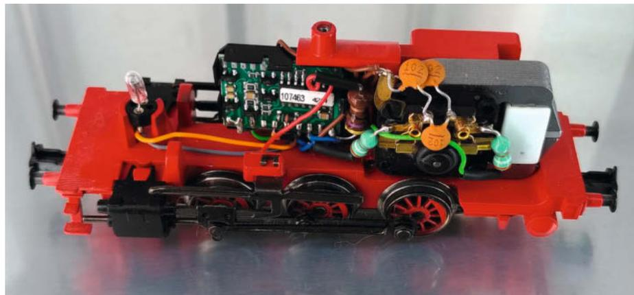
Innenleben einer neueren Digital-Dampflokomotive: Rechts der Motor in klassischer Bauform, aber mit Permanent-Magneten, in der Mitte der Digital-Dekoder.
