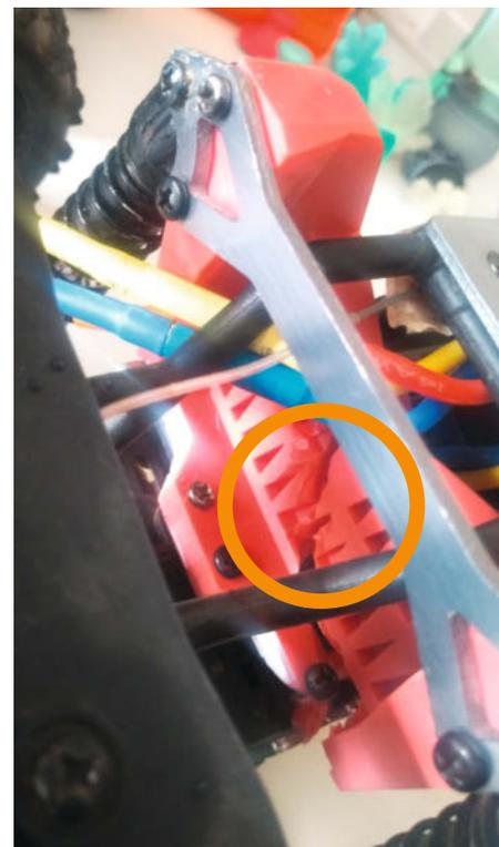
Nicht mehr so tough: Unter Belastung bricht das Resin der Dämpferbrücke direkt.
