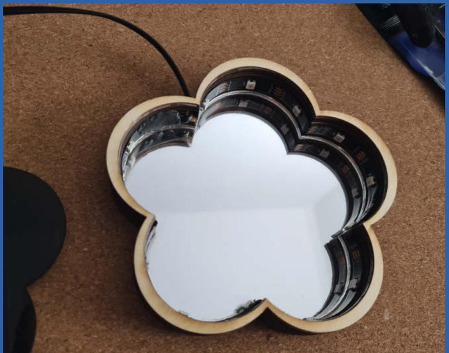
Das fertige Unterteil mit eingeklebtem Leuchtstreifen
