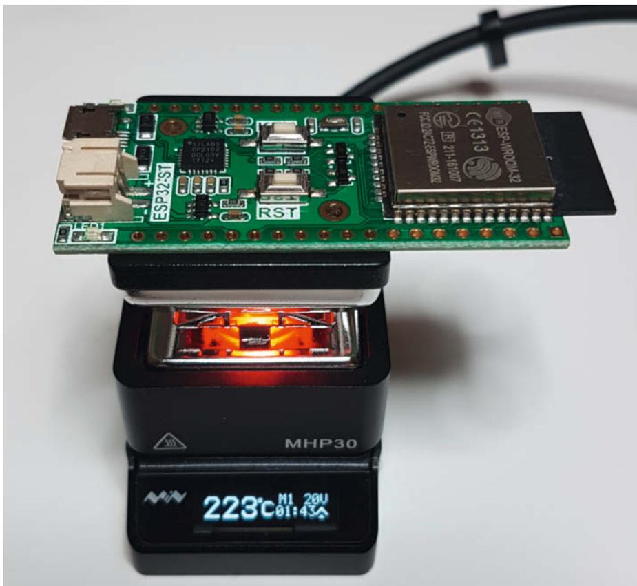
6 Mit einer Mini Heating Plate wird Muntzing zum Vergnügen.
