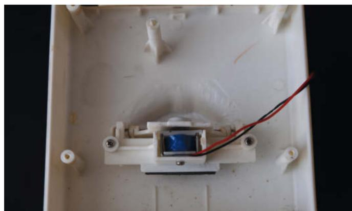
**2** Im Ruhezustand liegt der Dauermagnet am Hebel der Unterlippe am Elektromagnet an.
