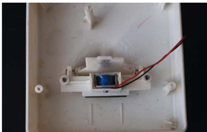
**3** Fließt ein Strom durch die Spule, wird der Dauermagnet abgestoßen. Die Lippe auf der anderen Seite bewegt sich nach unten.
