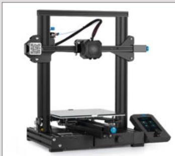
Seit Juli ist mit dem Ender 3 V2 der Nachfolger des beliebten Bausatz-3D-Druckers Creality Ender 3 (siehe Make 5/19, S.18) erhältlich. Von diesem unterscheidet sich die neue Version durch Verbesserungen an Mechanik und Elektronik. So sind nun die lang vermissten Riemenspanner für die X- und Y-Achse eingebaut. Mittels Rändelschrauben sind so die Antriebsriemen sehr schnell korrekt justiert.
