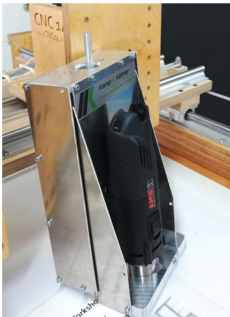
Die neue Z-Achse wird aus Aluminium gefertigt.
