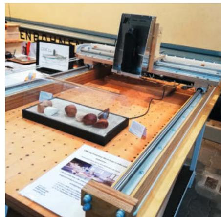
Die Fräse CNC14 ging aus der Make-Sperrholzfräse hervor und erhielt einige Verbesserungen.
