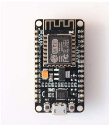
4 Das NodeMCU-Board stellt noch mehr Anschlüsse zur Verfügung.
