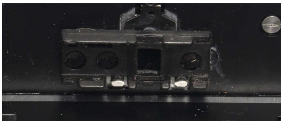
Das Bildfenster bei Super8 ist  $5,69\text{mm} \times 4,22\text{mm}$  groß und sitzt zusammen mit dem Filmtransport-Greifer in einer Führungsschiene.
