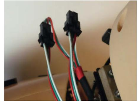
Die Kabel zum Kopf können über Steckverbindungen schnell getrennt werden.
