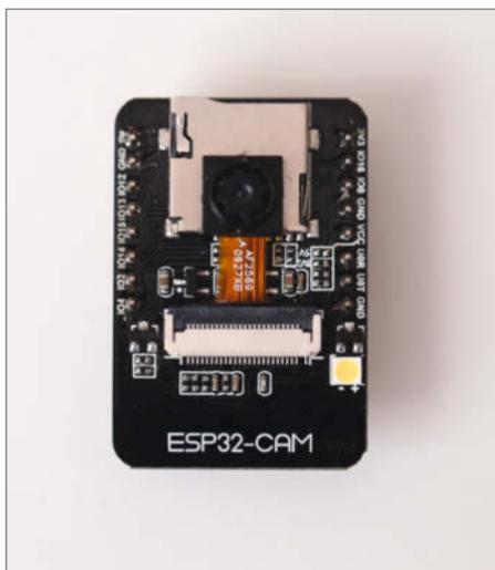
5 Das ESP32-Modul mit 2-Megapixel-Kamera ist kaum größer als ein D1-Mini-Board.
