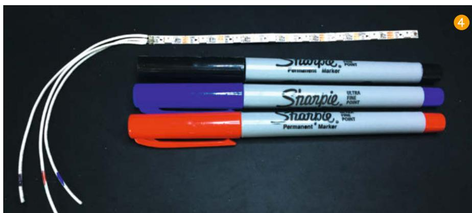
die drei Lötflächen an die Dateneingangsseite des LED-Strips löten. Es geht leichter, wenn man viel Flussmittel auf die Kontakte gibt. Der weiße Draht wird hinter dem klaren Acrylglas nahezu unsichtbar. Das ist zwar ästhetisch ansprechend, allerdings kann man die Versorgungs-, Masse- und Signalleitungen jetzt nicht mehr so gut unterscheiden. Daher markiere ich die Drähte mit verschiedenfarbigen Filzstiften **4**. Zur Zugentlastung decke ich die Lötverbindungen mit etwas Schrumpfschlauch ab.
