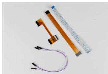
cher Auflösung ist nicht möglich. Das Modul selbst ermöglicht nur einen Abstand von gut 10cm zwischen den Kameras. Für eine längere Distanz sind entsprechende zusätzliche Folienkabel notwendig. —hgb
