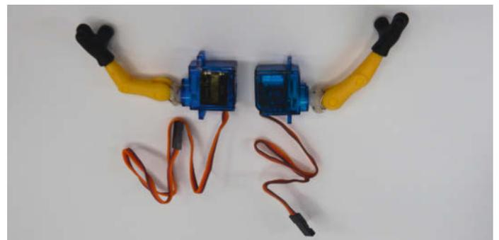
**3** Die Arme sind mit jeweils einem 9g-Servo verbunden; dessen Drehachse bildet direkt das Schultergelenk.
