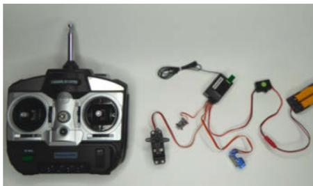
7 Eine Funkfernsteuerung nebst Empfänger, Batterie und drei Servos
