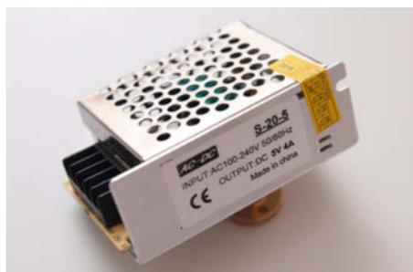
3 Nicht gerade VDE-gerecht, aber mit 4A leistungsfähig genug für den Druckerserver-RasPi.
