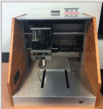
Das Gerät richtet sich preislich zwar eher an kleinere Firmen, Makerspaces und FabLabs, ist mit einer Grundfläche von 20cm x 20cm aber sehr kompakt und dank eines Aluminiumrahmens sehr steif – eine grundlegende Voraussetzung für eine präzise Materialbearbeitung. Eine Plexiglas-Klappe, die den Arbeitsraum komplett verschließt, reduziert die Belastung durch Staub und Lärm am Arbeitsplatz auf ein Minimum. Der Spindeltrieb ist eine Eigenkonstruktion aus einem BLDC-Motor und einer Riemenübersetzung.
