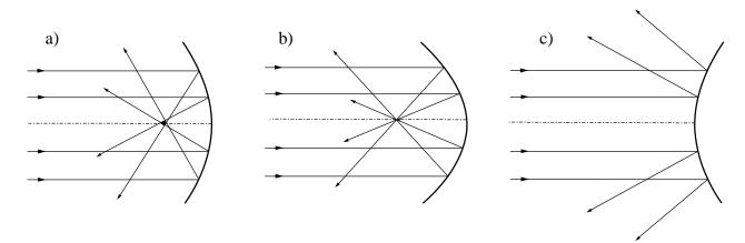
Das Licht trifft sich näherungsweise in einem Punkt und läuft dann "auseinander". Das Licht trifft sich in einem Punkt und läuft dann "auseinander". Das Licht wird in unterschiedliche Richtungen reflektiert.
