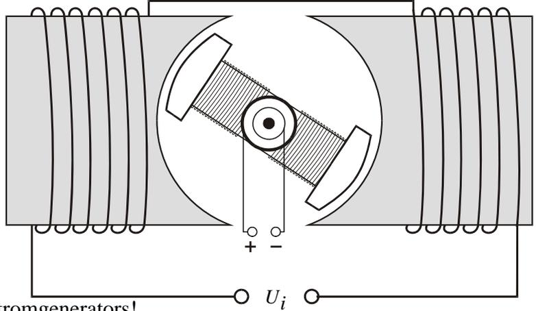
3. Erkläre die Wirkungsweise eines Wechselstromgenerators!
