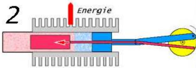
Durch die Bewegung des Verdrängerkolbens, aufgrund der Drehung des Schwungrades, wird das gerade erhitze Arbeitsgas in den Kühlzylinder verdrängt. Dort gibt sie Energie in Form von Wärme an den Kühlkörper ab. Seine Temperatur sinkt von  $T_1$  auf  $T_2$ . Der Arbeitskolben bewegt sich dabei kaum, da er sich am hinteren Totpunkt vorbeibewegt.
