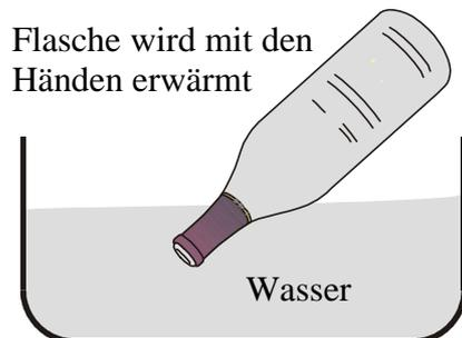
*Aus der Flasche treten Luftblasen aus. Durch die Erwärmung der Flasche wird auch die Luft in ihr erwärmt und dehnt sich aus. Ein (geringer) Teil der Luft tritt aus.*
