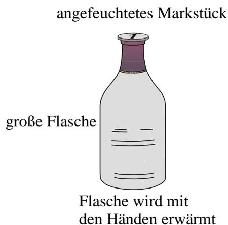
*Das Markstück „klappert“ einige Male. Durch die Erwärmung der Flasche wird auch die Luft in ihr erwärmt und dehnt sich aus. Durch die Luft wird das Markstück angehoben. Es tritt Luft aus. Bei weiterer Erwärmung wiederholt sich dieser Vorgang.*
